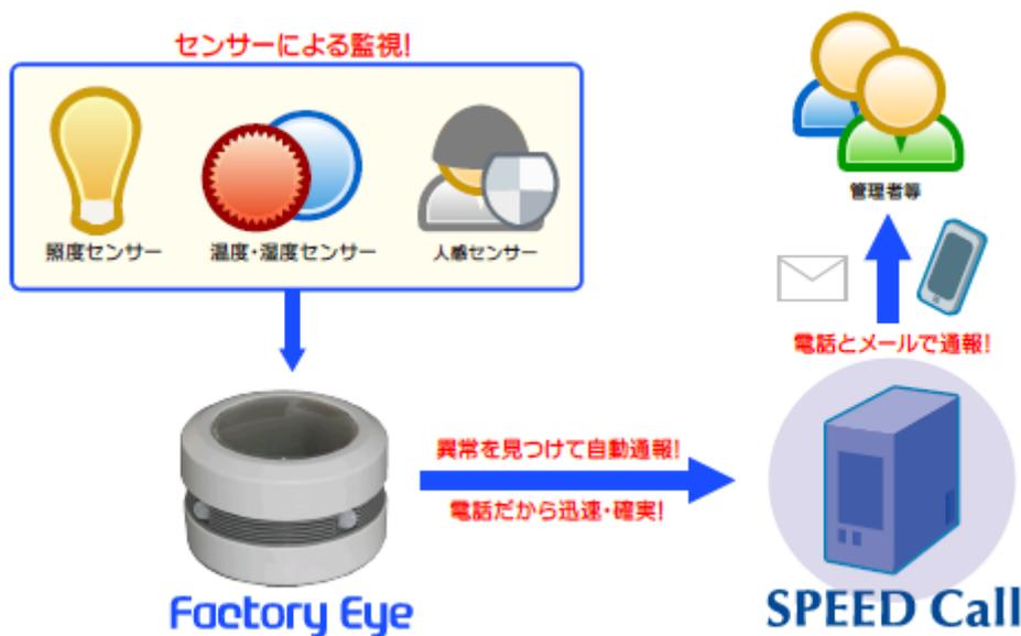
Factory Eye SPEED Call対応版は、4つのセンサーと拡張ポートを通報のトリガーとして利用できるにもかかわらず、高さ6.5cmで直径10cmの円筒型とコンパクトな作りで、本体の設置だけすれば利用可能なためオフィスやご家庭に気軽に設置できるほか、インターネットを通じてSPEED Callと連動するため通知の為に専用の回線なども必要ありません。
